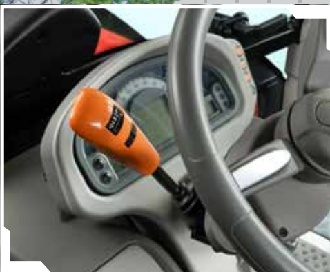
Powershuttle mit SenseClutch, Stop&Go und ComfortClutch verfügbar.
