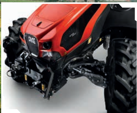
ActiveDrive - gefederte Vorderachse mit Einzelradaufhängung.
