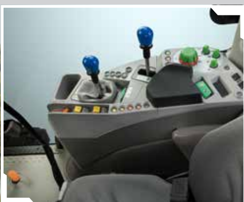
Mechanischer Kreuzhebel zur Aktivierung von 4 hydraulischen Anschlüssen zur gleichzeitigen Steuerung.
