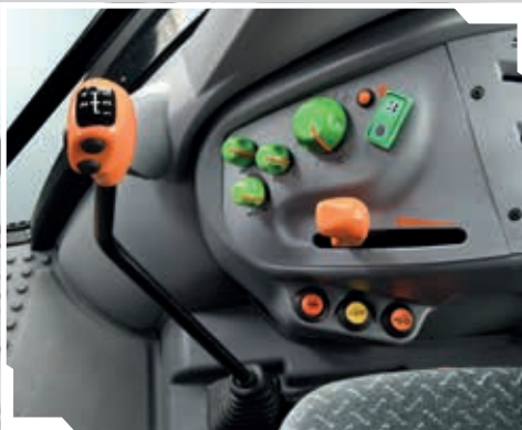
Elektronischer Heckkräftheber mit Schwingungsdämpfung.
