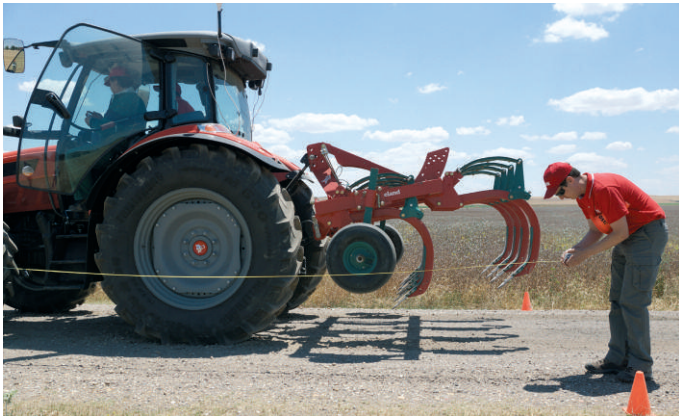
Ensayo de frenada en pista: los cuatro frenos de disco mostraron su eficacia a pesar del gran peso del conjunto.
