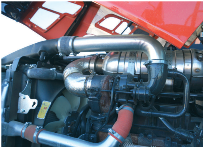
Detalle del sistema de recirculación de gases del motor Deutz TCD 3.6 L 04 Tier 4i.
