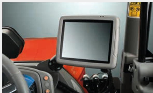
Le Frutteto CVT, le Frutteto CVT S et le Frutteto CVT V peuvent également être équipés du moniteur 8" dans l'angle droit du tableau de bord, à l'aide d'un support réglable.
