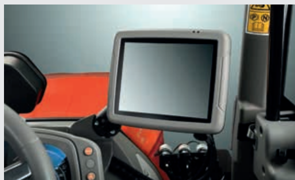
Die Modelle Frutteto CVT, Frutteto CVT S und Frutteto CVT V können außerdem mit dem 8" iMonitor ausgestattet werden, der mit einer verstellbaren Halterung rechts an der Instrumententafel angebracht ist.
